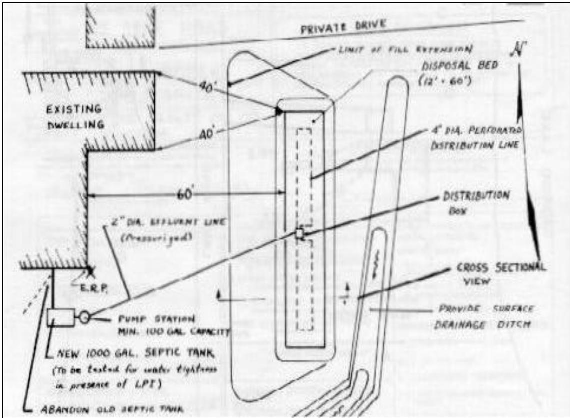
**SUBSURFACE WASTEWATER DISPOSAL PLAN:**
